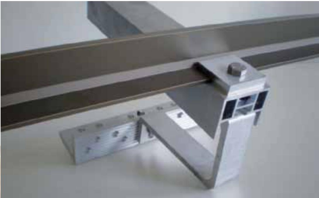
1. Profilschiene auf den montierten Dachhaken setzen und mit Hilfe der Nutensteine und Sechskantschrauben am Dachhaken befestigen.
