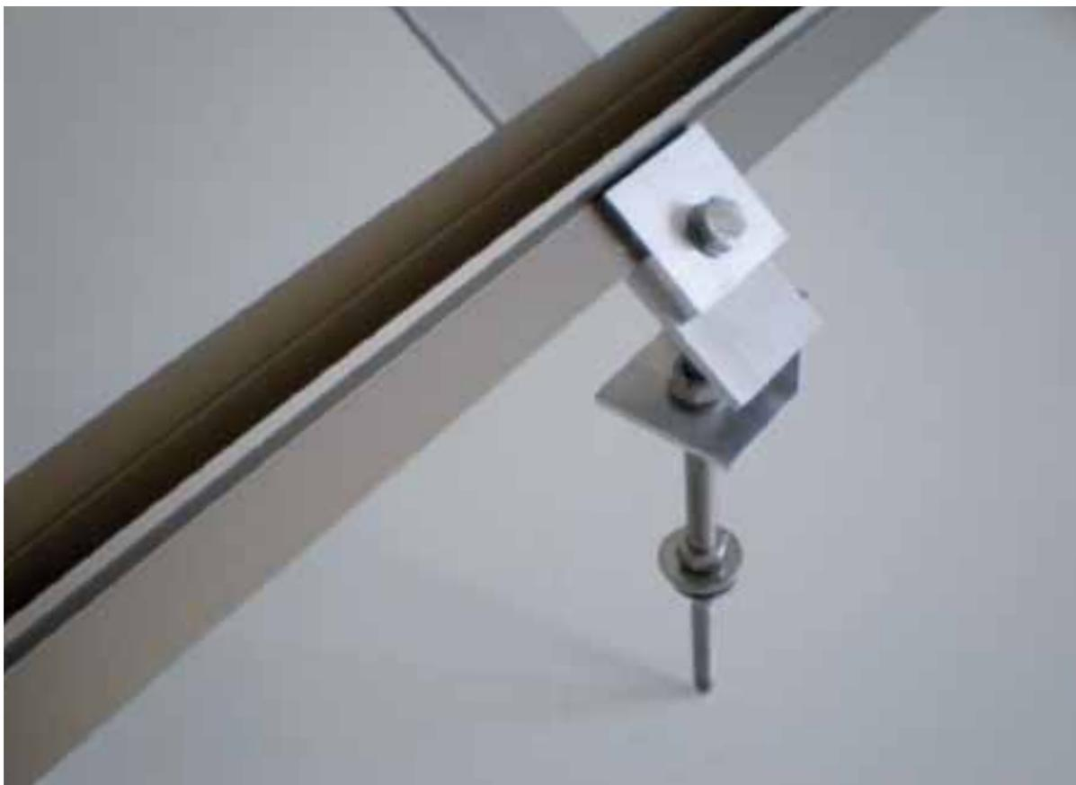
Bei der Montage von Schrägdachbefestigungen werden lt. Abbildung bereits gebohrte Neigungsschienen, welche auch in den angehobenen Befestigungsvarianten zu finden sind, verwendet. Diese Neigungsschienen sind mit Hilfe der Befestigungswinkel an die jeweilige Dachbefestigung zu schrauben. (Ausnahme 6.1 ziegelparallele Ausführung)
